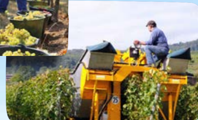
Der Vollernter erntet die Trauben maschinell. Er fährt durch die Reihen und rüttelt sanft an den Reben, bis die Trauben abfallen.
