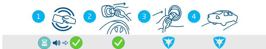
Figuur 4.8: Het laadproces starten met gebruikersautorisatie/RFID-laadpas. Symbolen die worden weergegeven op de gebruikersinterface
