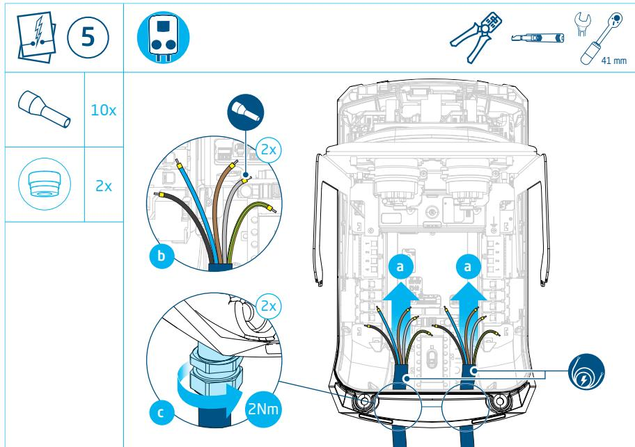
6. Connectez le(s) cordon(s) d'alimentation à l'interrupteur-sectionneur et à la borne PE. Serrez les vis à un couple de 2 Nm. Utilisez l'illustration correspondant à votre variante de produit : un ou deux cordons d'alimentation.
