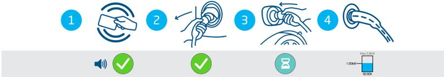
Figura 4.7: Avvio del processo di ricarica con l'autorizzazione dell'utente / carta RFID. Simboli visualizzati sull'interfaccia utente
