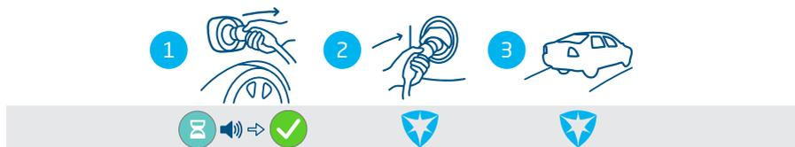
Figura 4.6: Interruzione del processo di ricarica senza carta RFID. Simboli visualizzati sull'interfaccia utente
