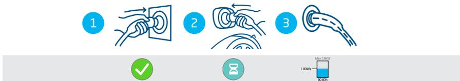
Figura 4.1: Avvio del processo di ricarica senza carta RFID. Simboli visualizzati sull'interfaccia utente
