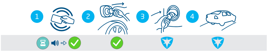
Figura 4.8: Arresto del processo di ricarica con l'autorizzazione dell'utente / carta RFID. Simboli visualizzati sull'interfaccia utente
