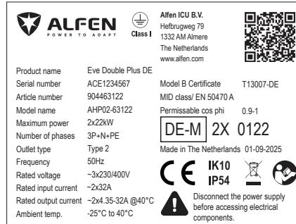
Abbildung 2.9: Typenschild für Eve Double Plus mit Steckdose und 2 Stromversorgungskabeln
