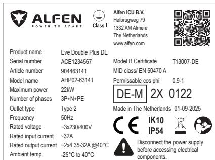
Abbildung 2.12: Typenschild für Eve Double Plus mit Steckdose und 1 Stromversorgungskabel und Überspannungsschutz (SPD)
