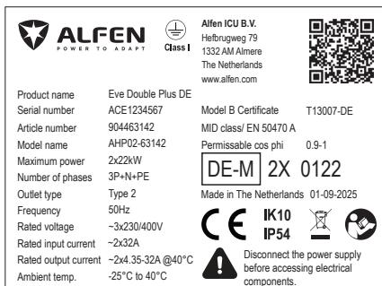
Abbildung 2.13: Typenschild für Eve Double Plus mit Steckdose und 2 Stromversorgungskabeln und Überspannungsschutz (SPD)
