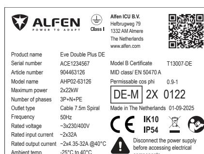
Abbildung 2.11: Typenschild für Eve Double Plus mit fest installiertem Ladekabel und 2 Stromversorgungskabeln
