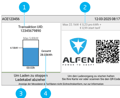
Abbildung 2.27: Display der Eve Double Plus Ladestation: angezeigte Informationen während der Ladesession
