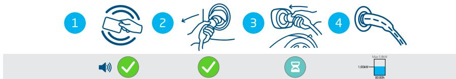
Figura 4.7: Iniciar el proceso de carga con autorización de usuario/tarjeta RFID. Símbolos que aparecen en la interfaz de usuario
