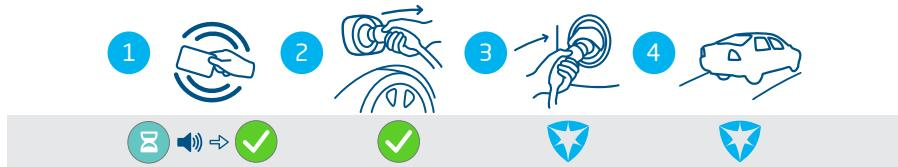
Figura 4.8: Parada el proceso de carga con autorización de usuario/tarjeta RFID. Símbolos que aparecen en la interfaz de usuario
