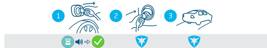
Figura 4.6: Detener el proceso de carga sin tarjeta RFID. Símbolos que aparecen en interfaz de usuario
