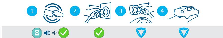
Figura 4.4: Parada el proceso de carga con autorización de usuario/tarjeta RFID. Símbolos que aparecen en la interfaz de usuario
