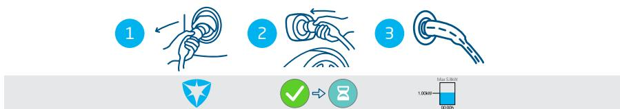
Figura 4.5: Iniciar el proceso de carga sin tarjeta RFID. Símbolos que aparecen en interfaz de usuario
