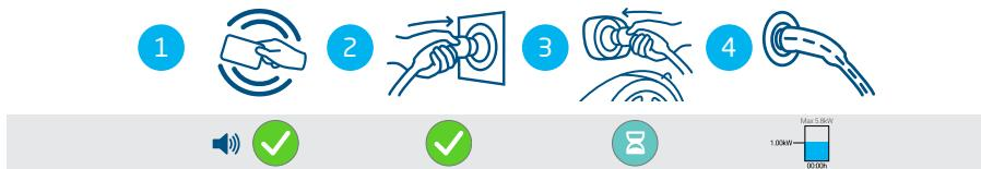
Figura 4.3: Iniciar el proceso de carga con autorización de usuario/tarjeta RFID. Símbolos que aparecen en la interfaz de usuario
