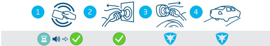
Abbildung 4.4: Stoppen des Ladevorgangs mit Anwenderberechtigung/RFID-Karte. Auf der Anwenderoberfläche angezeigte Symbole
