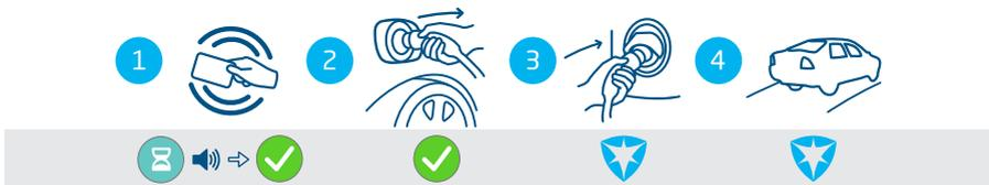
Abbildung 4.8: Stoppen des Ladevorgangs mit Anwenderberechtigung/RFID-Karte. Auf der Anwenderoberfläche angezeigte Symbole
