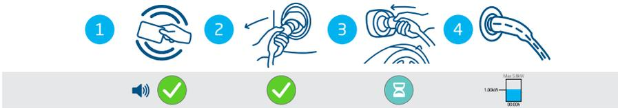
Abbildung 4.7: Starten des Ladevorgangs mit Anwenderberechtigung/RFID-Karte. Auf der Anwenderoberfläche angezeigte Symbole
