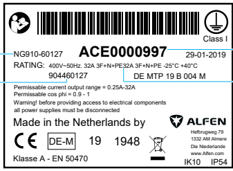
Abbildung 3.2: Typenschild für Ladestation mit fest installiertem Ladekabel
