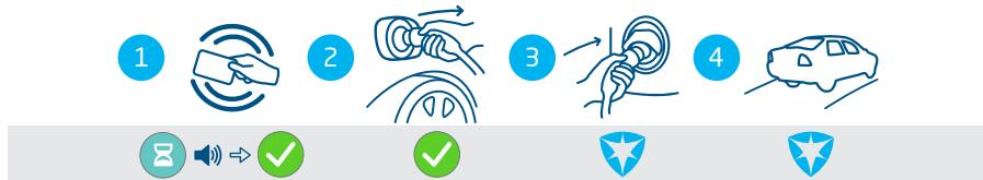
Figura 4.8: Arresto del processo di ricarica con l'autorizzazione dell'utente / carta RFID. Simboli visualizzati sull'interfaccia utente
