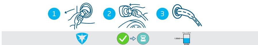
Figura 4.5: Avvio del processo di ricarica senza carta RFID. Simboli visualizzati sull'interfaccia utente
