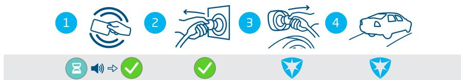
Figura 4.4: Arresto del processo di ricarica con l'autorizzazione dell'utente / carta RFID. Simboli visualizzati sull'interfaccia utente
