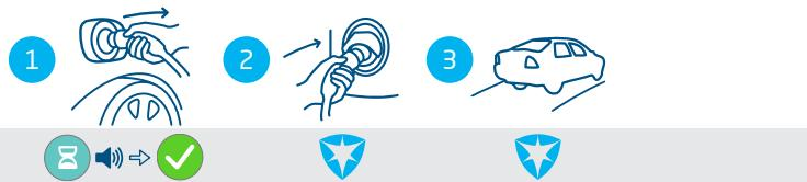
Figura 4.6: Interruzione del processo di ricarica senza carta RFID. Simboli visualizzati sull'interfaccia utente
