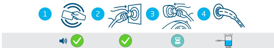
Figura 4.3: Avvio del processo di ricarica con l'autorizzazione dell'utente / carta RFID. Simboli visualizzati sull'interfaccia utente
