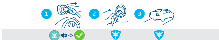
Illustration 4.6: Arrêt du processus de recharge sans carte RFID. Symboles affichés sur l'interface utilisateur
