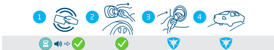
Illustration 4.8: Arrêt de la procédure de charge avec une autorisation utilisateur / carte RFID. Symboles affichés sur l'interface utilisateur
