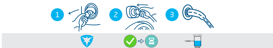
Illustration 4.5: Démarrage du processus de recharge sans carte RFID. Symboles affichés sur l'interface utilisateur
