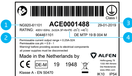
Abbildung 2.1: Typenschild für Ladestation mit einfacher Stromversorgungskabel
