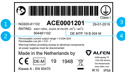
Abbildung 2.2: Typenschild für Ladestation mit doppelter Stromversorgungskabel
