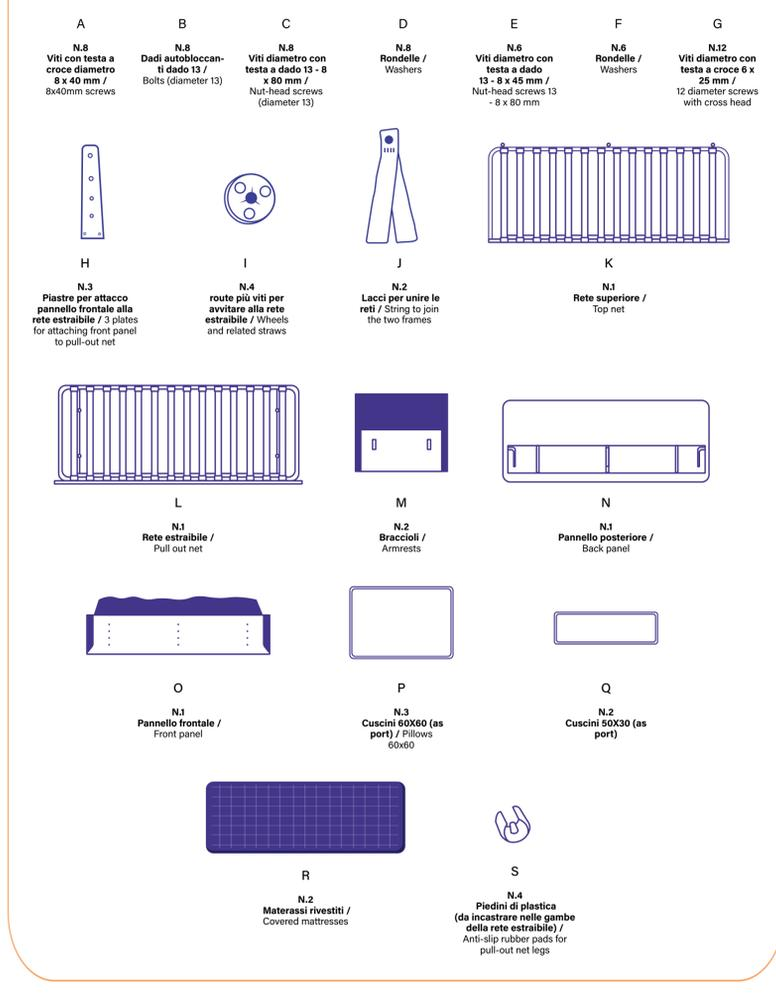
**1** Avvitare il pannello posteriore (N) alla rete superiore sul lato più largo (K) con le 6 viti 8x45 con testa a dado (E) e le rispettive rondelle (F).
