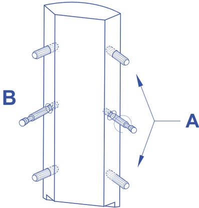
Antes de comenzar con la estructura preparamos las patas con las piezas A y B, tal y como se muestra en la ilustración.
