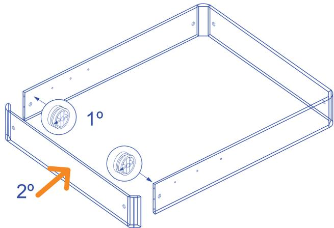
Colocamos las piezas D (embellecedores) sobre cada pieza C, anteriormente colocadas en el paso 2.
