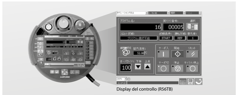
Permette l'inserimento/il disinserimento automatico dei servomotori, l'avvio e l'arresto, il ripristino, la scelta dei programmi e altre funzioni.
