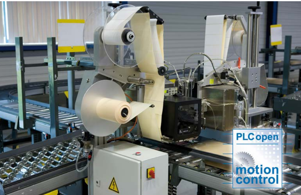
Etiquetadora controlada por un PLC de la serie L de MELSEC, en combinación con un módulo Simple Motion.
