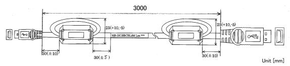
Fig.1-5: USB cable (MR-J3USBCBL3M)
