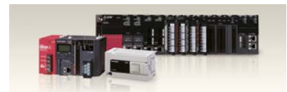
PLCs compactos y modulares
