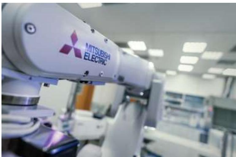
**Immagine 4:** Il robot industriale di Mitsubishi Electric dispone di un braccio a lunga portata e un set di strumenti a controllo robotico per eseguire analisi su microscala con micropiastre a 96 e 384 pozzetti.
