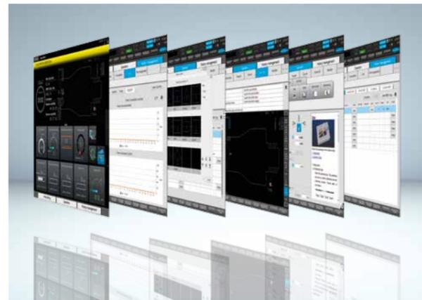
Il dialogo interattivo permette agli utenti con meno esperienza di essere guidati passo dopo passo attraverso l'intero processo di lavorazione, dalla programmazione all'avvio del taglio. Le liste di controllo sono importanti per rivedere le impostazioni relative alla lavorazione mentre gli indicatori permettono di identificare lo stato della macchina con un semplice colpo d'occhio.
