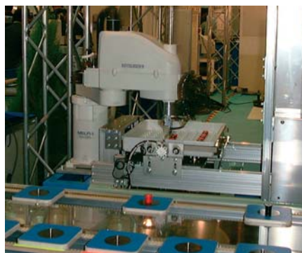
Uporaba robota RH-6SDH v procesu paletiranja.
