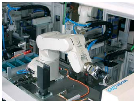
Uporaba robota RV-2SDB v običajno tesnih prostorih.
