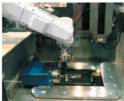
RV-3SDB pri delu na žično-erozijskem stroju.
