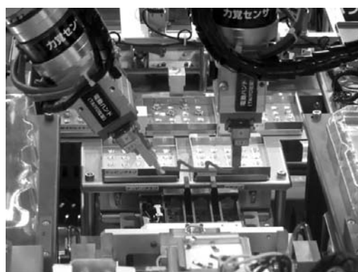
A megfogók egymáshoz képesti relatív pozíciói a telepítés teljes idején változatlanok maradnak.
