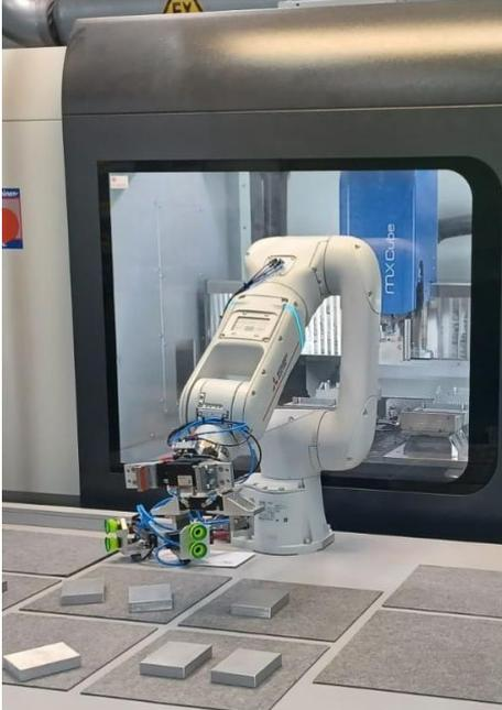
**Bild 1:** Schutzlos, mannlos, sorglos: die Bestückung einer Fräsmaschine mit dem Assista Cobot und 3-D Kameratechnik.
