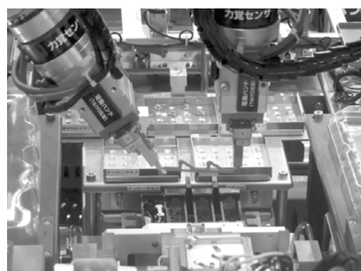
Umożliwia zakończenie prac montażowych w czasie, gdy pozycje chwytaków na robotach pozostają niezmiennie.
