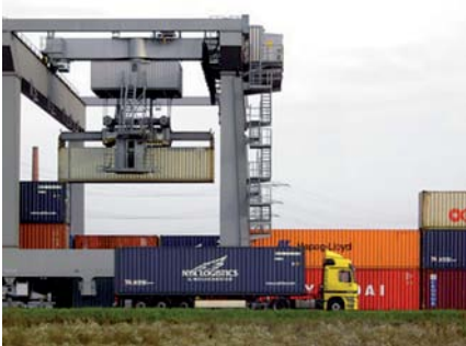
A függő terhek a motor és a kódoló közötti visszacsatolásnak köszönhetően pontosan pozícionálhatók.
