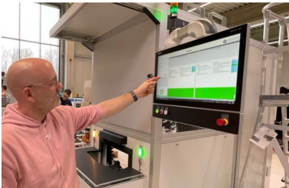
Der Test- und Kalibriervorgang kann über ein Touchdisplay parametrisiert und gestartet werden“, erklärt Martin Nieskens, Team Leader ADAS System Design bei NOFFZ.
