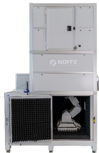
Die Universelle Tester Plattform UTP von NOFFZ testet und kalibriert Radarsensoren, die beispielsweise in Automobilanwendungen eingesetzt werden
