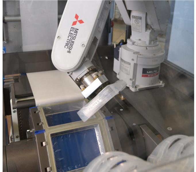
Servosteuerungs- und Sicherheitsmodulen MELSEC-WS sowie einem HMI der Baureihe GOT2000. Als Option wurde ein MELFA RV-F Knickarmroboter integriert. Alle Komponenten sind über das offene Netzwerk CC-Link angebunden. Um die verlangte Funktionalitätsdichte zu erreichen, war Mitsubishi Electric von Anfang an an Entwicklung, Konzeption und Umsetzung beteiligt.
