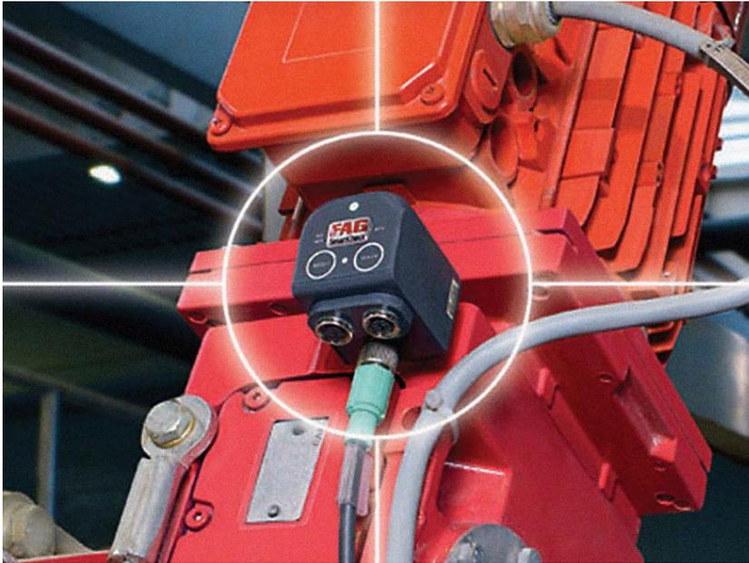
Einfache Montage der SmartCheck-Sensoreinheit mit einer Schraube oben auf dem Motor oder dem Getriebe, und Anschluss mit nur einer Leitung, weil die Spannungsversorgung über das Ethernet (PoE) erfolgt.
