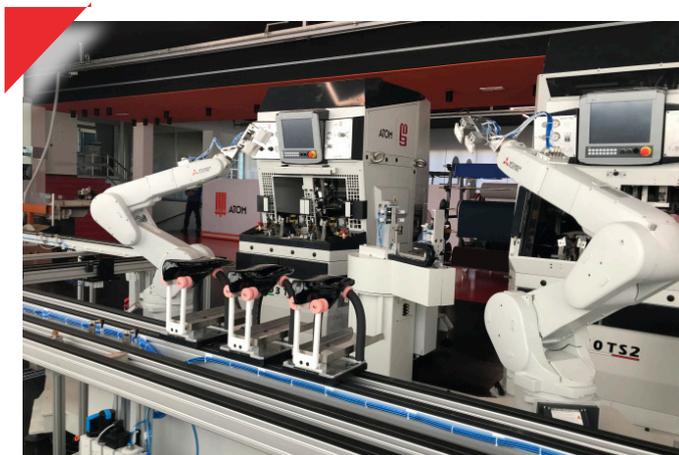
Il principio di funzionamento prevede che dagli organi di trasporto, ogni singola scarpa semilavorata venga depositata su un appoggio specifico, studiato per garantire la compatibilità con qualsiasi modello e taglia di scarpa, senza provocare danni alle scarpe. Per far sì che la flessibilità sia massima, gli organi di presa e di appoggio derivano da uno studio approfondito e prolungato con differenti livelli di prototipizzazione 3D, fino al raggiungimento dell'ottimo.
