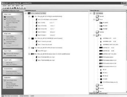
Il software GX Configurator DP è un programma "user friendly" per la configurazione della rete aperta Profibus DP.
