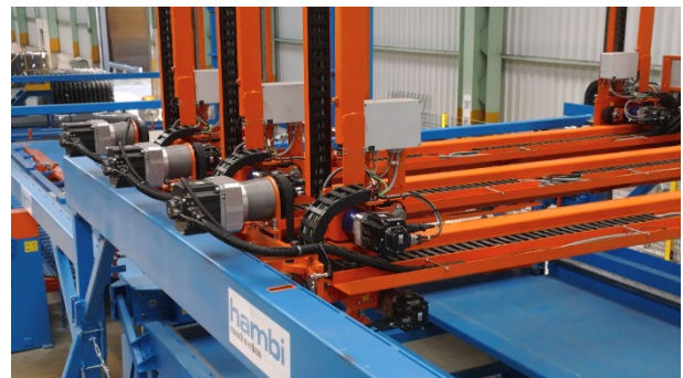
Sechs Greifer heben die Baustahlmatte an, Servoantriebe von Mitsubishi Electric sorgen für deren Bewegung in alle drei Raumrichtungen
