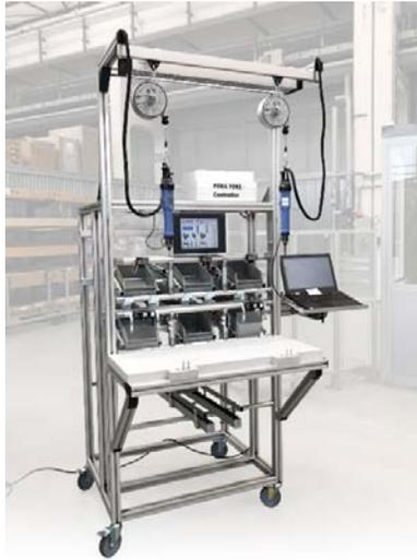
**Bild 1:** Das Poka Yoke System leitet die Bediener durch manuelle Montage und Kommissioniervorgänge durch ein breites Spektrum an Sensorik und Aktorik von Lichtschranken und Drucktastern bis hin zu Türmechanismen, Elektroschraubern und Barcode-Scannern.
