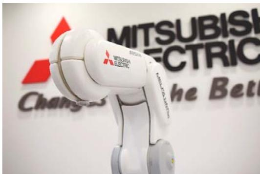
**Bild 2:** Mit der intelligenten Option MELFA SafePlus können die Roboter von Mitsubishi Electric am Handarbeitsplatz installiert werden, um mit dem Menschen verschiedenste Prozesse gemeinsam oder unterstützend zu erledigen.
