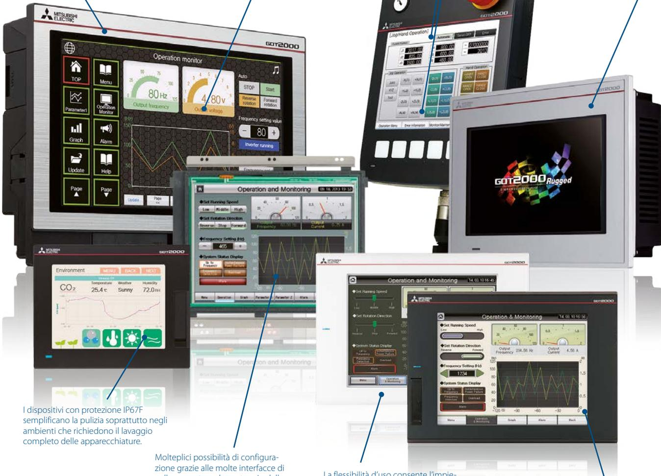
I dispositivi con protezione IP67F semplificano la pulizia soprattutto negli ambienti che richiedono il lavaggio completo delle apparecchiature.
