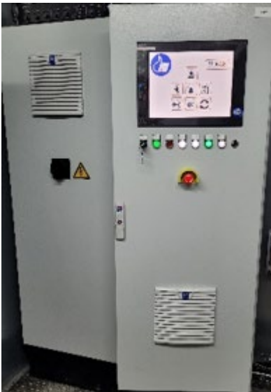
Bild 5: Schaltschrank mit Mitsubishi Electric GOT2000 HIMI
