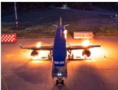
Bild 1 und 2: Nachbau eines A320/B737-Flugzeugs für Trainingszwecke
