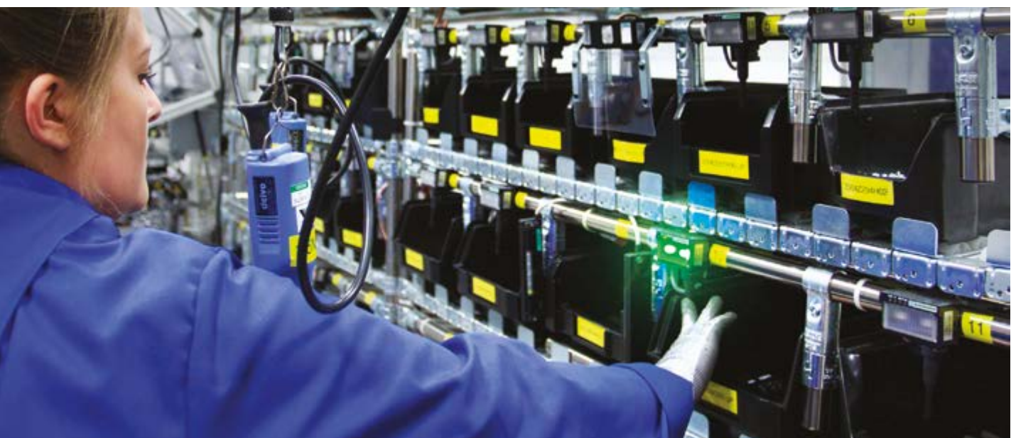
Anzeigen oder Türen führen den Bediener zur korrekten Entnahmebox
