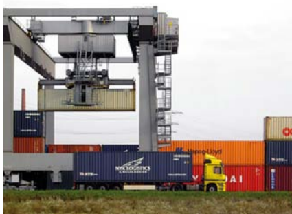
Zavesené pohyblivé bremená je možné presne položiť pomocou motora a spätnej väzby z enkódera.
