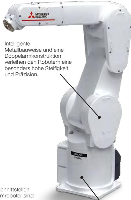
Intelligente Metallbauweise und eine Doppelarmkonstruktion verleihen den Robotern eine besonders hohe Steifigkeit und Präzision.
