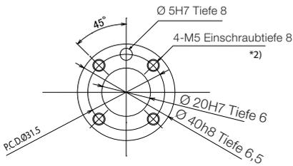
Ansicht A: Detailsicht der mechanischen Schnittstelle
