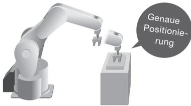
Störende Vibrationen während der Positionierung werden durch den innovativen Vibrationskontrollalgorithmus von Mitsubishi Electric effizient unterdrückt. Dies führt zu einer um 30% reduzierten Einschwingzeit, was die Zykluszeiten optimiert und somit die Gesamtproduktivität signifikant erhöht.
