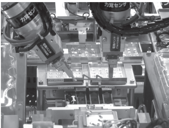
Die relativen Positionen der Handgreifer zueinander bleiben während des gesamten Installationsvorgangs unverändert.
