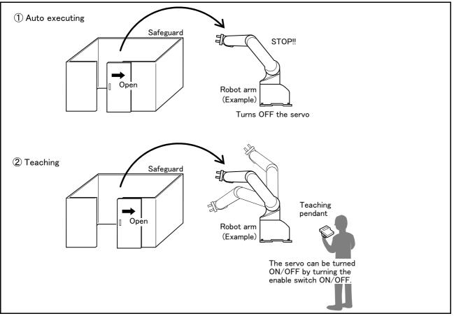
Fig.3-16 : Door switch function
