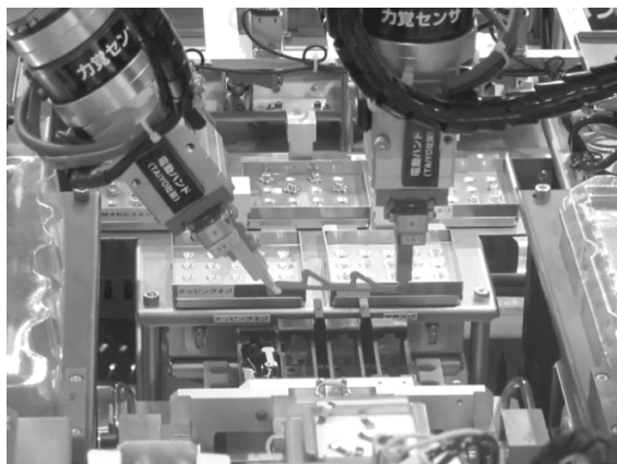
Las posiciones relativas de las pinzas de las manos entre sí permanecen invariables durante toda la operación de instalación.
