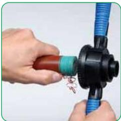
**3-** Roscar de a una vuelta por vez, desenroscando en cada caso 1/4 de vuelta al final para retirar los filetes del material tallado.
