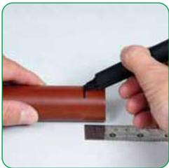
**1-** Cortar el tubo en forma perpendicular a su eje. Si el elemento utilizado para cortar (sierras o tijera) deja rebarbas, retirarlas.
