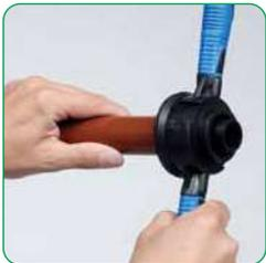
**2-** Colocar la terraja a 90° del eje del tubo.
