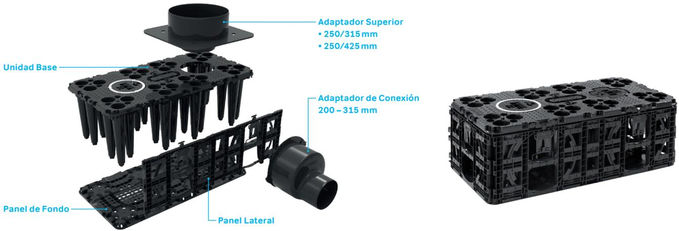
Figura 1: Componentes del sistema AquaCell y unidad modular ensamblada
