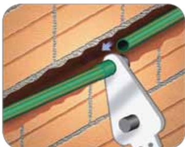
**4.-** Luego de la fusión de la cupla en una de las puntas del tubo, coloque la boquilla macho en el otro extremo de la cupla y mantenga el doble de tiempo recomendado en la tabla de tiempos de termofusión, retirando el termofusor enseguida.
