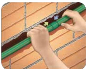
**6.-** Finalmente, inserte inmediatamente la punta del tubo en el extremo de la cupla, presionándolo hasta su posición original en la canaleta de la pared.
