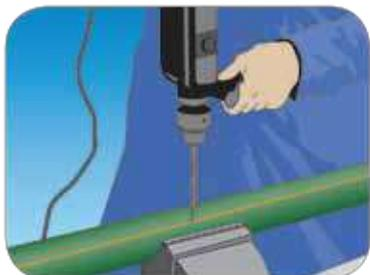
**1.-** Usando un taladro con broca de 12 mm, hacer un agujero en la tubería en el lugar donde deberá colocarse la derivación. El agujero debe ser perpendicular a la superficie del tubo. Utilice las líneas guías del tubo como referencia para la perforación.
