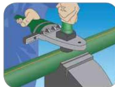
**4.-** Una vez transcurrido el tiempo de la Tabla 14, iniciar el calentamiento de la montura de derivación. Mantener el termofusor calentando ambos componentes (tubo y montura) hasta que se forme un cordón uniforme de cerca de 2 mm de material fundido, tanto a lo largo del tubo como de la montura.
