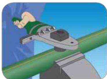
**3.-** Colocar en la termofusora las bocas especiales para montura de derivación. Limpie las boquillas de la termofusora y las superficies de la montura y del tubo con un paño embebido en alcohol. Realizar una marca sobre la superficie del tubo de manera de indicar la posición correcta de montaje de la montura sobre el tubo. Con la boquilla adecuada, caliente primero ligeramente el tubo, utilizando los tiempos de la Tabla 14.
