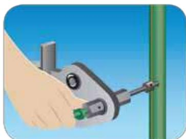
**2.-** Con la Boquilla de Reparación ya colocada en el agujero, introduzca un tarugo de reparación del lado hembra de la boquilla.
