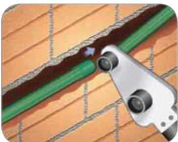
**5.-** Inserte inmediatamente la boquilla hembra en la otra punta del tubo que está en la pared, manteniendo el tiempo recomendado en la tabla de tiempos de termofusión.
