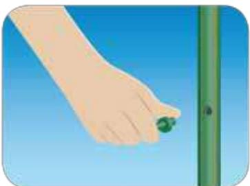
**3.-** Luego de 5 segundos, retire la boquilla de reparación del tubo y también el tarugo del termofusor. Con ambos en caliente, introducir el tarugo en el agujero.
