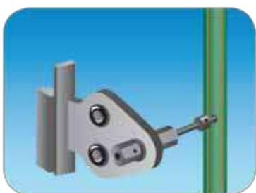
**1.-** Acople la boquilla del termofusor, aguarde hasta llegar a 260°C, e introduzca la punta macho de la boquilla en el agujero.
