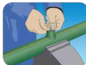
**5.-** Retirar el termofusor y colocar inmediatamente la montura sobre el tubo, observando la correcta posición de la misma, indicada por la marca realizada anteriormente. Luego de la termofusión de la montura sujete firme por 20 a 30 segundos. Durante un intervalo de 3 segundos, existe la posibilidad de alinear angularmente la salida de la montura, pero sin girarla. Dejar enfriar la unión durante un mínimo de 10 minutos
