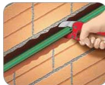
**1.-** Corte en forma perpendicular la parte damnificada del tubo.
