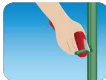
**4.-** Aguarde 2 minutos, para el enfriamiento, y corte la punta sobresaliente del tarugo.
