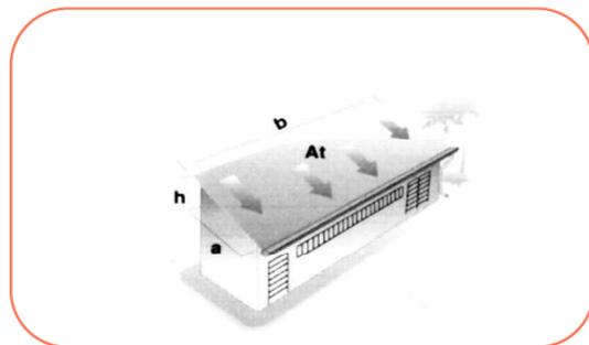
Exemplo: hipoteticamente, em uma casa na região de Teresina-PI (com intensidade pluviométrica de 240 mm/h, segundo a NBR 10844), possui cobertura de duas águas, no qual cada uma delas possui 5m de
