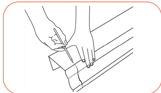
6º Para ser possível executar cortes retilíneos no perfil, encaixe um suporte, marque o contorno com lápis e execute o corte a partir deste contorno. Remova as rebarbas.
