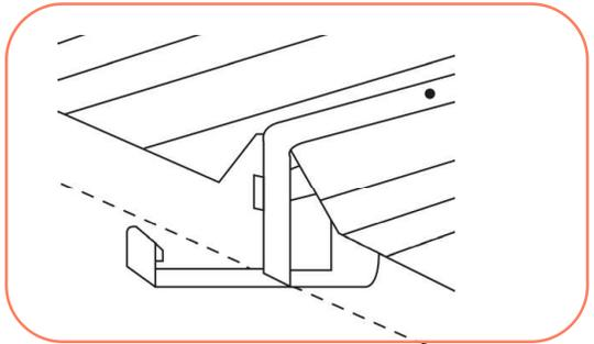
5º Faça as medições dos trechos necessários de perfil, considerando a marcação indicada na parte interna da conexão até a mesma marcação da conexão seguinte. É importante seguir esta instrução para permitir a dilatação térmica do sistema.
