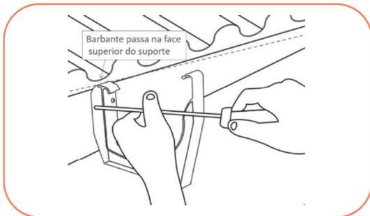
No caso do beiral sem testeira, os pontos de fixação já estão predefinidos pela posição dos caibros. Os suportes devem ser aparafusados sobre o caibro, respeitando a declividade e 0,5% (o grampo do suporte metálico é fixado na face traseira – menor – do perfil).
