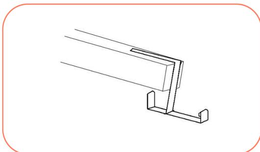
Já para coberturas metálicas, os suportes metálicos também podem ser utilizados, fixando-os diretamente na estrutura. Faça a marcação da dobra necessária na haste e siga a instalação respeitando a declividade e 0,5%.
