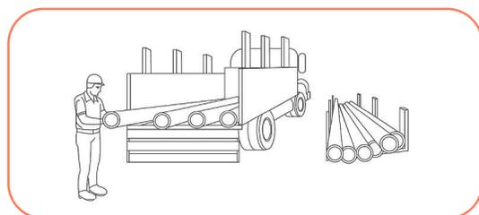
O local de armazenamento deve ser plano e bem nivelado, para evitar deformações permanentes.
