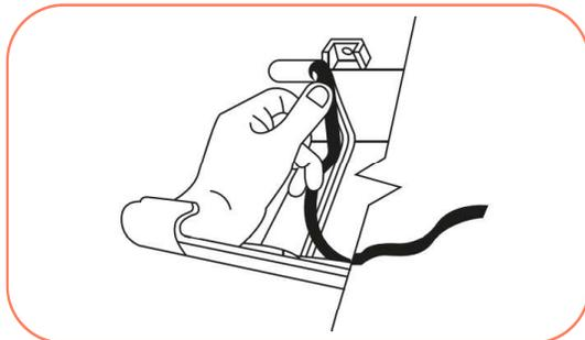
8º A calha deverá ser encaixada nos suportes e nas conexões já fixados na testeira ou nos caibros: encaixe primeiro a parte traseira e gire a calha para baixo, como mostram as figuras. Importante respeitar a marcação na parte interna da conexão e verificar se a vedação permanece na posição adequada.
