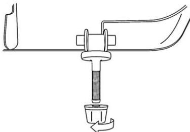
2º Encaixe o assento na louça sanitária, certificando que os dois parafusos entrem no furo de forma nivelada;
