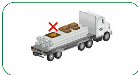
Evitar que parte da tubulação fique em balanço na carroceria principalmente em longos trajetos de deslocamento.
