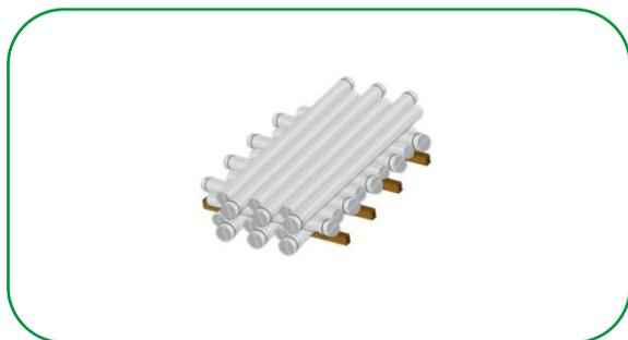
Realizado por meio da utilização de cruzamento longitudinal dos tubos para amarração das pilhas, sem a utilização de suportes laterais, utilizando sarrafos de madeira no sentido transversal a primeira camada, espaçados de 1,5 m.
