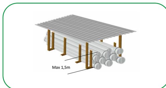
As barras de tubo devem ser dispostas em camadas, na forma horizontal a uma altura máxima de até 1,5 metros ou sobre pallets com empilhamento recomendável não superior a 2 unidades.
