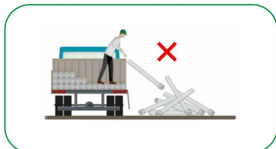
A tubulação suporta o manejo normal da obra e pode ser facilmente carregada/descarregada manualmente (diâmetros até 450mm) ou com equipamento (500mm até 1.000mm) fazendo uso de cordas ou cintas de nylon. O uso de qualquer material metálico, como correntes ou cabos de aço, NÃO é recomendado, pois pode danificar as tubulações.
