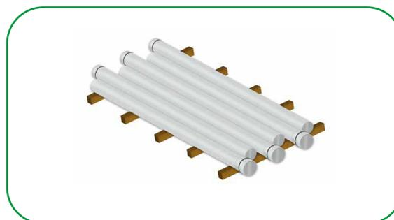
A exposição a intempéries, principalmente aos raios ultravioletas por tempo prolongado, pode alterar a resistência ao impacto no transporte e manuseio dos tubos e a vida útil dos anéis.
