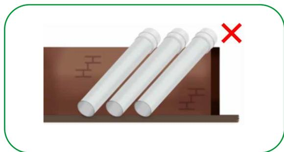
O armazenamento / estocagem dos tubos e conexões Amanco Wavin deve ser em locais isentos de quaisquer elementos que possam danificar o material tais como: superfícies rígidas com arestas vivas, objetos cortantes ou pontiagudos, pedras, etc.
