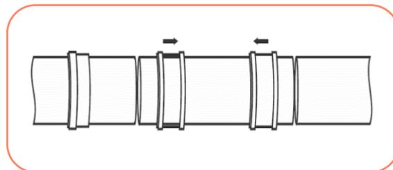
3º Deslize as luvas uma contra a outra e encaixe o segmento do tubo com as luvas, após desloque as luvas de correr para o centro, posicionando sobre os cortes.
