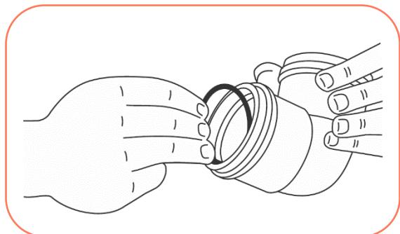
4º Aplique uma camada de Pasta Lubrificante na ponta do tubo e na parte visível do Anel de Vedaçāo;
