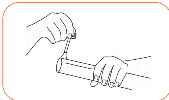
4º Juntar as duas peças, forçando o encaixe até o fundo da bolsa, sem torcer. Após, remova o excesso de Adesivo Plástico PVC com um pano. Aguardar o tempo especificado para submeter o sistema ao teste hidráulico (12 horas para adesivo plástico PVC e 24 horas para adesivo plástico PVC de grandes diâmetros).
