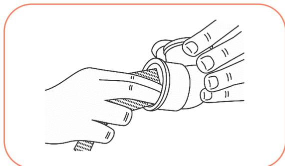
2º Limpar as superfícies lixadas com Solução Preparadora, eliminando as impurezas que podem impedir a ação do Adesivo Plástico PVC;
