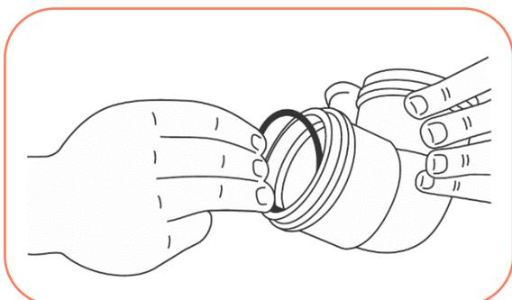
4º Aplique uma camada de Pasta Lubrificante na ponta do tubo e na parte visível do Anel de Vedação;
