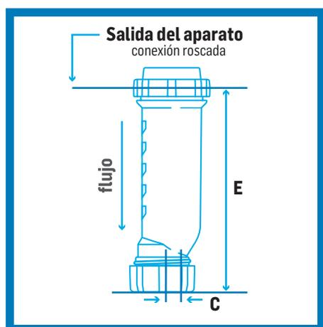
Instalado verticalmente directamente a la salida del aparato sanitario.
