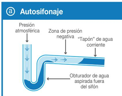
Los sifones convencionales funcionan con un sello de agua para evitar que entren malos olores en los edificios. Sin embargo, un sifón con sello de agua puede fallar bajo varias condiciones. Los siguientes diagramas muestran varios problemas que resultan en la pérdida del sello de agua, gorgoteo y malos olores.
