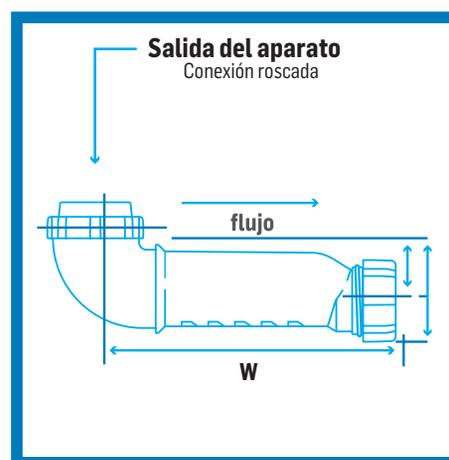
Se fija horizontalmente a la salida del dispositivo mediante el adaptador tipo codo.
