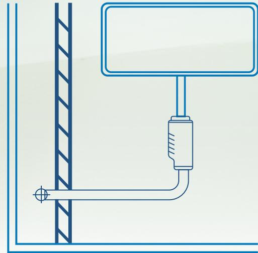
**Figura 5:** Válvula autosellante para drenaje de condensados
