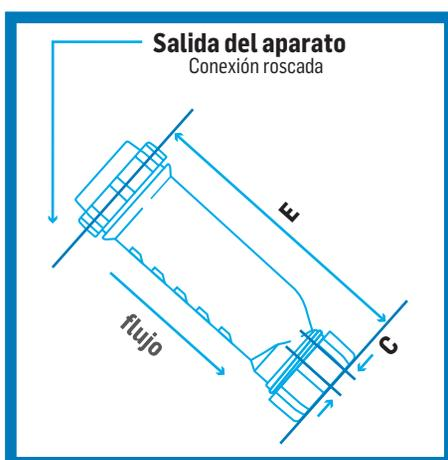
Fijado en una tubería en cualquier ángulo inclinado usando un adaptador en línea.
